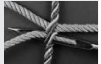
Figura 10: Cómo se abre cada hebra para hacer el ply splitting
